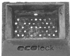
Brasier qui a besoin de nettoyage, avec les trous bouchés par la cendre
